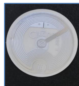
図 1 NFC タグの写真 大きさは 10 円硬貨とほぼ同じ大きさである。
