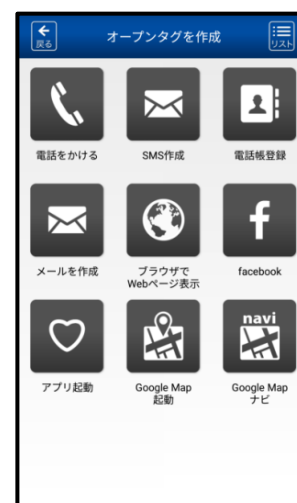
図 3 NFC タグを読み取った後に動作を設定する画面。
