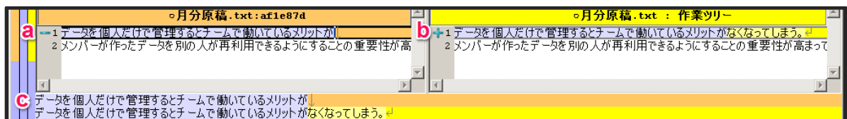
図 1 テキスト形式ファイルの 2 つのバージョンで差分を表示させた。変更のあった行は強調表示される(図中 a,b)。変更があった行にマウスポインターを重ねると画面下にどのような変更かを同一行を上下に表示し比較できる(図中 c)。この例では、左側に古いバージョンが表示されている。「なくなってしまう。」という部分が抜けていたので追加したことがわかる。ファイル上部の色は、バージョンを比較している行の色に対応している(図中 b)。
